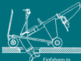
Einfahren in Güllegrube
