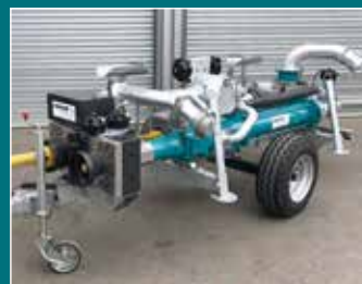
Pumpe 120 m 3 /h aufgebaut auf PW1600
