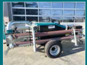
Ausblaskompressor und Steinfangkiste aufgebaut
