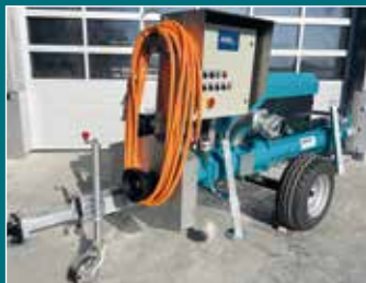
Schneckenpumpe mit Ausblas- kompressor 30 kW
