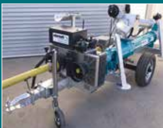
Pumpe 90 m 3 /h aufgebaut auf PW1300
