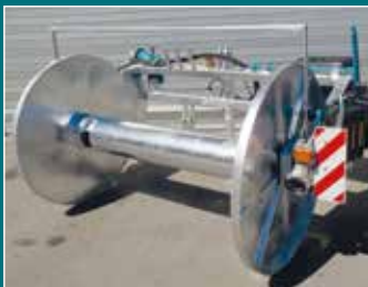
Schlauchhaspel mit Beleuchtung
