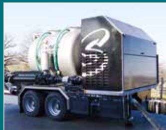
Maschine mit Schneidfilter, Düngerdosierung und Edeltank
