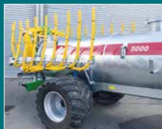
Schleppschlauch 7.2 m in Fahrstellung
