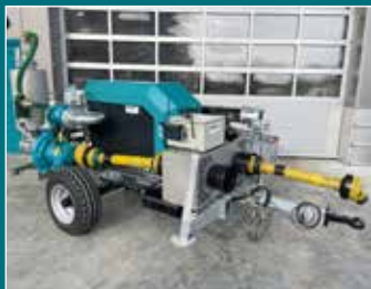
Pumpe und Ausblaskompressor auf Wagen aufgebaut
