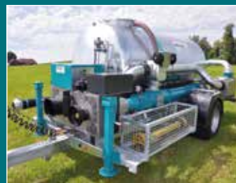
Pumpe 160 m 3 /h aufgebaut auf PW2500 mit Wassertank
