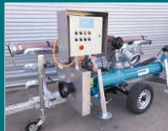
Schneckenpumpe auf Wagen aufgebaut
